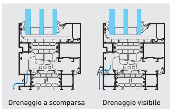
Drenaggio a scomparsa rispetto a drenaggio tradizionale attraverso il profilo e i tappi di drenaggio del telaio
